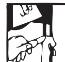
5 Corte o excesso depois de, no mínimo, 2 (duas) horas da aplicação. A cura total ocorre depois de 24 horas.
