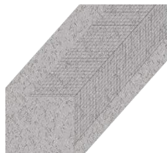
Reforço de canto com tela na horizontal.
