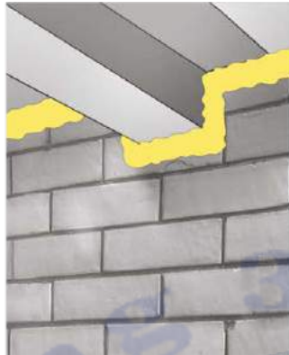
Encunhamento de alvenaria.
